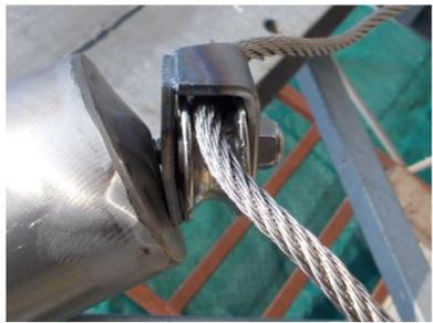
Particolare seconda campionatura - dispositivo rinforzato per prova dinamica e statica
