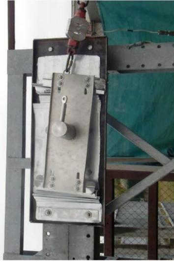
Dispositivo sottoposto a prova di resistenza statica 18 kN alle estremità
