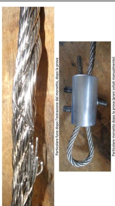
Particolare fune dopo l'estrazione dal morsetto, dopo la prova
