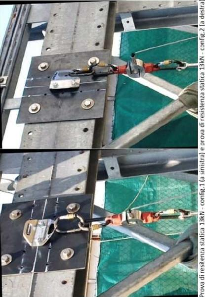
Prova di deformazione - config.1 (a sinistra) e all'estremo prova di resistenza dinamica per 2 operatori - config.2 (a destra)
