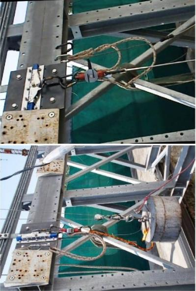
Prova di resistenza statica 13kN - config.1 (a sinistra) e prova di deformazione - config.2 (a destra)
