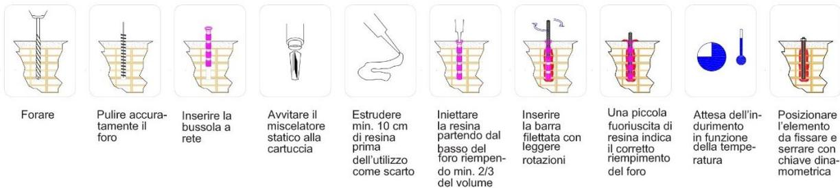
Istruzioni di posa: supporto in calcestruzzo con ancorante chimico
